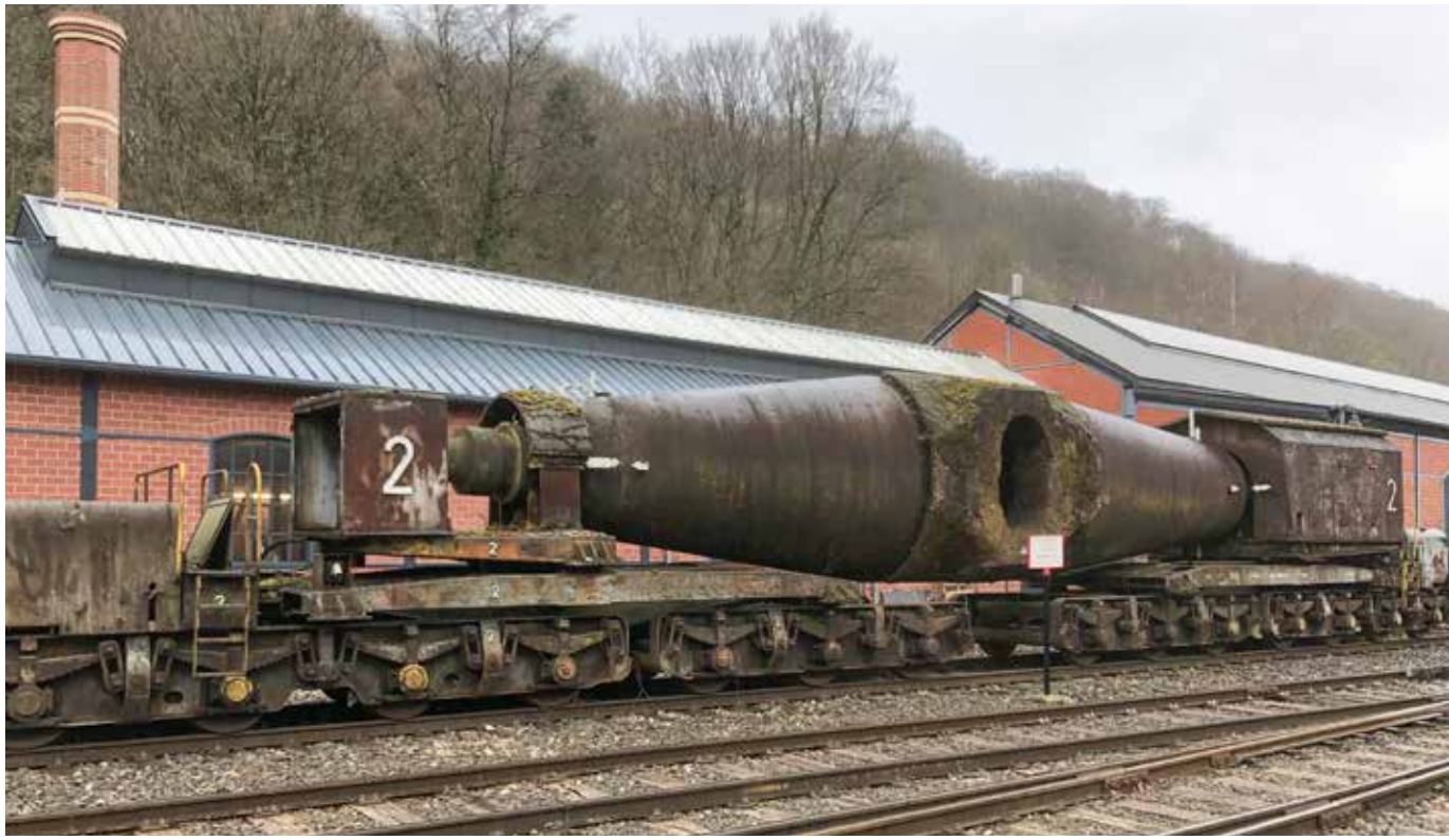
Le wagon appelé « Cigare » ou « Torpedo » est le dernier témoin des wagons ayant transporté de la fonte liquide entre les sites sidérurgiques.
