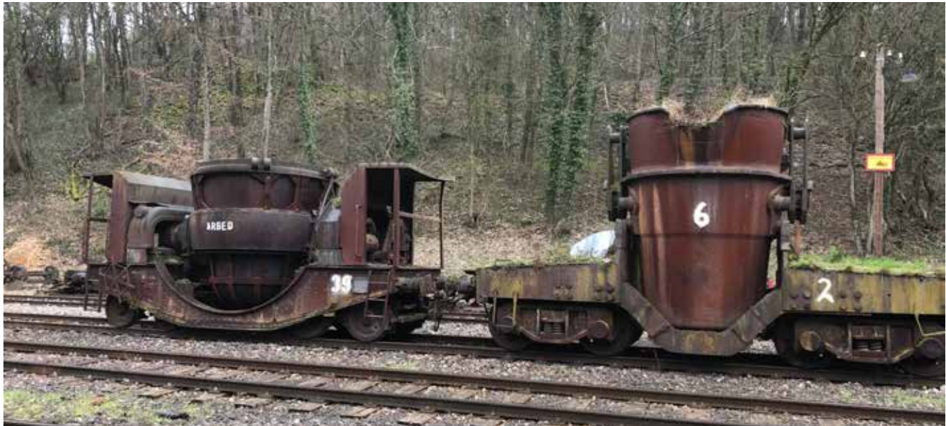
Les wagons à deux bennes basculables servaient l'industrie sidérurgique.
