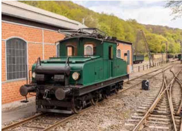
La locomotive électrique HADIR numéro 3, construite en 1912 par la Waggonfabrik Fuchs avec la technologie Siemens, est la plus ancienne des machines de ce genre conservée au Luxembourg. Elle a été utilisée comme train-navette pour le transport du laitier vers le terril à l'usine de Differdange.
