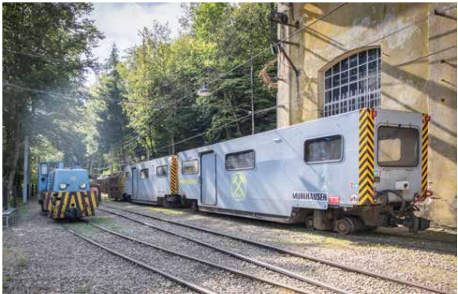
Les wagons de passagers de la société Mühlhäuser sont au service de la Minièresbunn depuis 2012. Ils sont équipés de freins à air comprimé et entièrement fermés lors des trajets à travers la mine. Un wagon peut accueillir jusqu'à 25 voyageurs.
