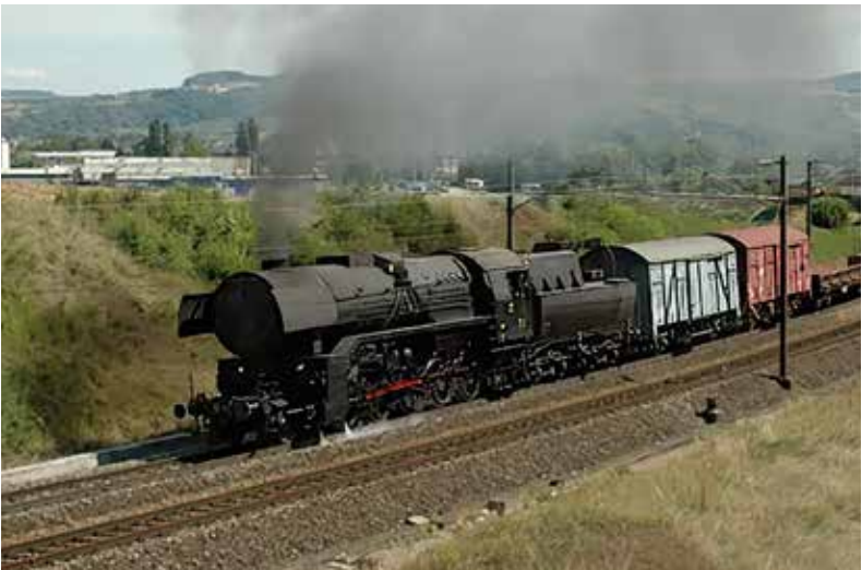
La GAR 5621 est une locomotive de guerre originale de la Deutsche Reichsbahn, construite en 1943 par KraussMaffei. Les Deutsche Kriegsloks étaient conçues pour répondre aux exigences des temps de conflits, causées e.a. par la pénurie de matériaux et les conditions difficiles de circulation et d'entretien. Ces locomotives ont encore été construites en grande quantité après la Seconde Guerre mondiale. À ses débuts, les CFL exploitaient plusieurs séries sur le réseau ferroviaire luxembourgeois, comme la série CFL 55 ou la série 56.
