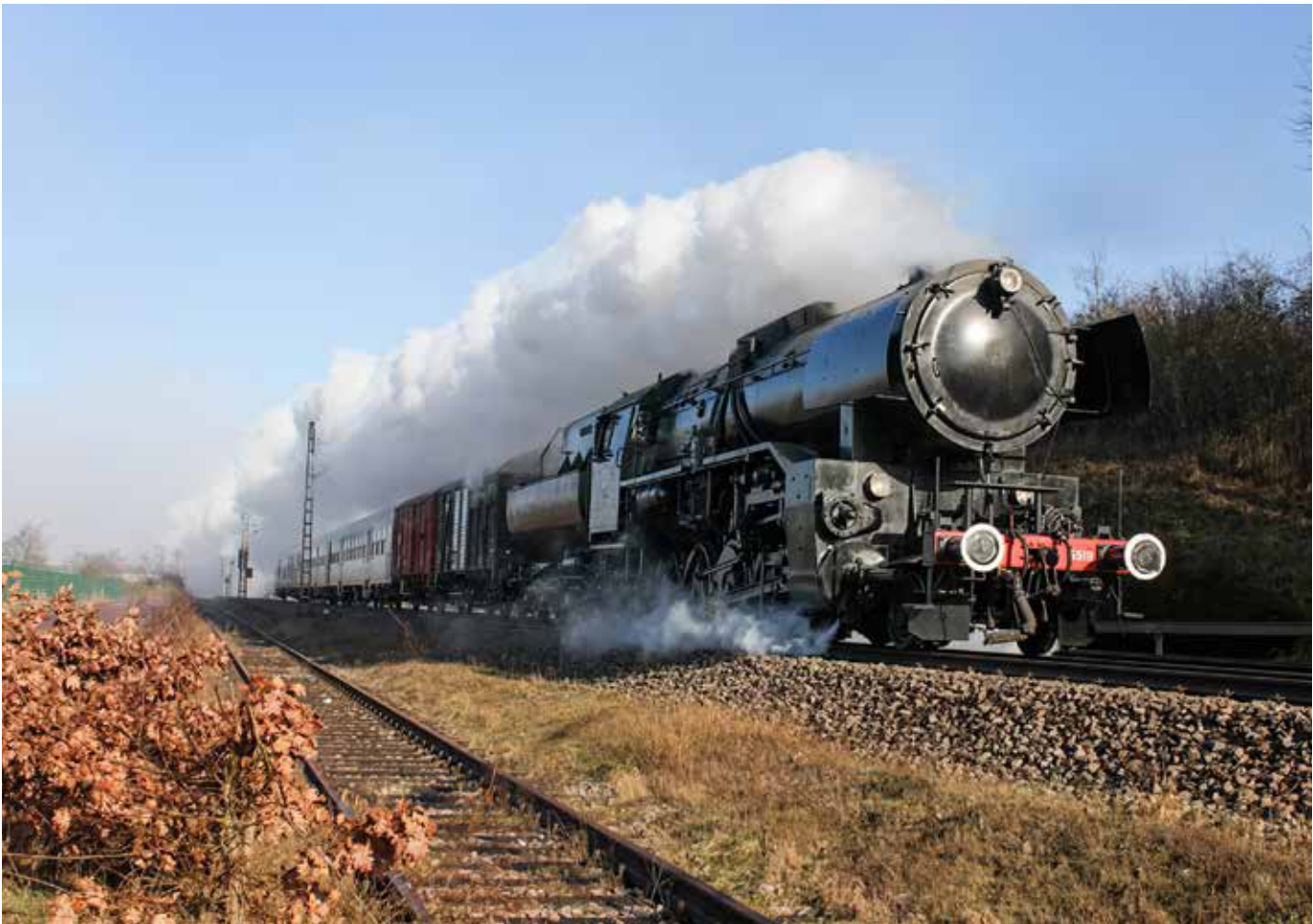
Les lourdes locomotives à vapeur de la série CFL 55, de type de guerre allemand BR 42, ont été construites par l'entreprise autrichienne Wiener Lokomotivfabrik Floridsdorf. Grâce à leur conception simplifiée et leur fiabilité, ces machines représentaient un choix économiquement intéressant pour les CFL. Les 20 locomotives mises en service par les CFL, livrées entre 1948 et 1949, furent retirées du service en 1964.
